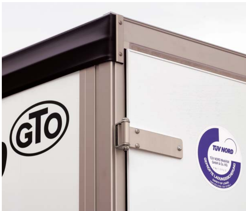
GETO Varioplan: Umlaufendes Profilwerk aus Aluminium eloxiert
